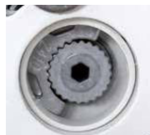
Bild 3: Die Verzahnung ist durch das Anziehen der Feststellschraube fixiert.
