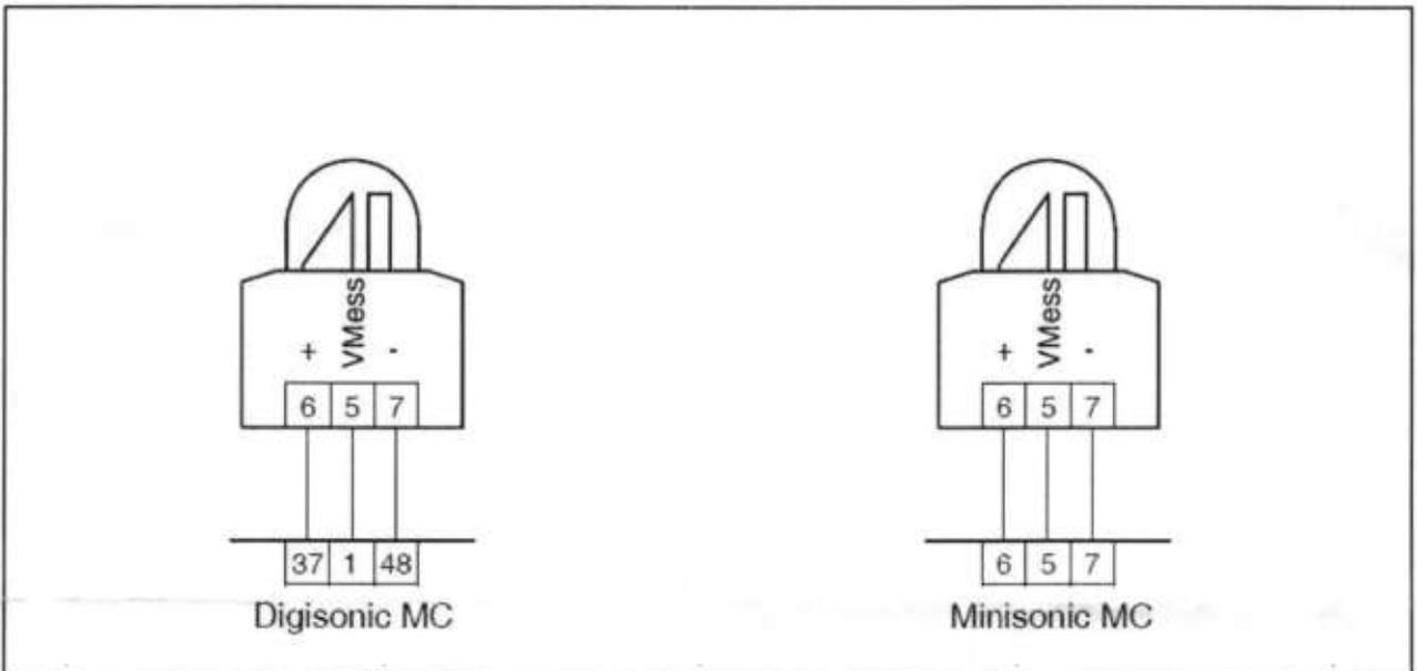
Bild 3: Anschluss an Sonnenschutzzentrale z.B. Digisonic MC (3630.20.0010) oder Minisonic MC (3632.40.0000)
