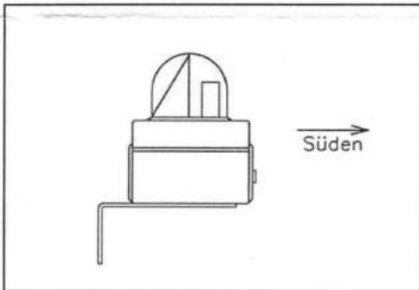
Bild 1: Sensor mit Befestigungswinkel z.B. bei Mastmontage
