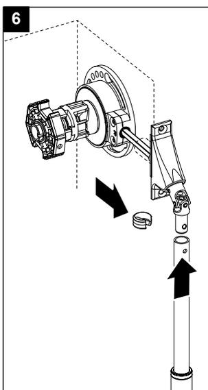
Schieben Sie die Kurbel auf den Zapfen des Gelenklagers und sichern Sie diese mit dem mitgelieferten Sicherungsclip.
