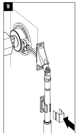
Sichern Sie die Kurbel mit dem Sicherheitsiegel, indem Sie es über den Halter kleben.
