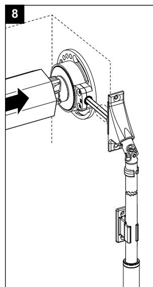
Verbinden Sie den Motor mit der Anschlussleitung und dem Stromnetz, schieben Sie die Welle mit dem eingebauten Motor auf den Mitnehmer des Getriebes und stellen Sie die Endlagen ein (siehe Bedienungsanleitung des Motors).
