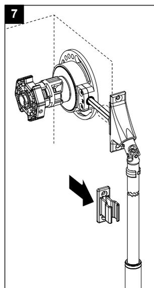
Befestigen Sie den Kurbelhalter mit 2 Schrauben (nicht im Lieferumfang enthalten) an der Wand.
