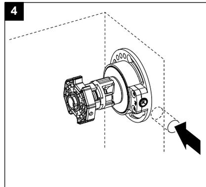
Bohren Sie ein Loch als Durchführung des Gelenklagers auf Höhe des Getriebeantriebs in das Mauerwerk.
