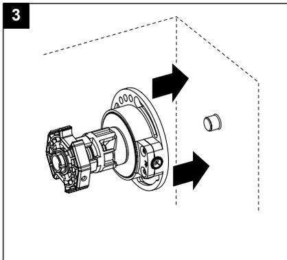
Befestigen Sie das Getriebe mit mindestens 2 Schrauben/Nieten am Seitenteil des Rollladenkastens (nicht im Lieferumfang enthalten).
