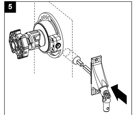
Führen Sie den Abtriebsstab des luftdichten Gelenklagers durch die Bohrung in das Getriebe. Schrauben Sie das Gelenklager mit 2 Schrauben (nicht im Lieferumfang enthalten) an der Wand fest.
